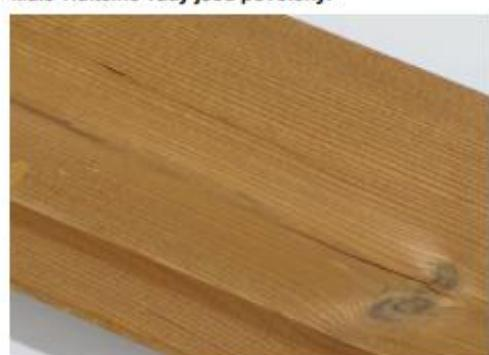
Malé podélné trhliny na povrchu jsou povoleny.
